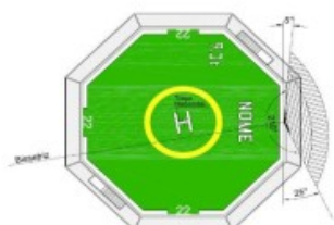
figura 6 - rotação do chevron em helideque regular.
